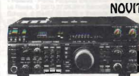
KENWOOD TS 850 S/AT - Ricetrasmittitore HF per SSB - CW - AM - FM - FSK Potenza 100W.
